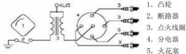
传统点火系统主要由蓄电池、凸轮、断路器、点火线圈、分电器、火花塞组成。蓄电池的作用是供给点火系统所需电能，凸轮和断路器接通或断开点火系统电源。点火线圈储存点火能量并将蓄电池电压转变为点火高压。断路器的作用是接通或切断点线圈初级电路；分电器的作用是将点火线圈产生的点火高压按照发动机的工作顺序输送至各缸火花塞。火花塞将点火高压引入气缸燃烧室，并在电极间产生电火花，点燃可燃混合气。这种点火系统的优点是维修检测相对容易，缺点之一是机械部件及电点火高压引入气缸燃烧室，并在电极间产生电火花，点燃可燃混合气。
