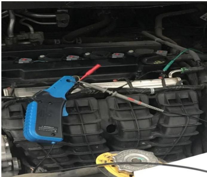
图 3 电流钳的使用方式
