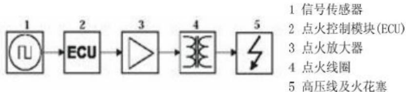
电控点火系统用一组传感器来收集与发动机相关的信息，如转速、冷却温度和发动机负荷等。位置传感器和转速传感器是点火系统需要的最重要的信息，这些信息来自叶轮传感器或凸轮轴传感器。点火控制模块根据收集到的信息计算点火时间和充电时间，如果某个传感器工作不正常，将导致输出信号不正确，因此现代的控制模块要检查传感器送来的信号是否真实可信，若有不可信的信号时有可能不输出任何信号。点火控制模块输出的信号不能直接驱动点火线圈，要经过点火放大器进行放大。实际上一般都把点火放大器安装在点火线圈内，这种情况下初级点火信号是测不到的；或者安装在点火控制模块内，这种情况下点火控制模块输出信号是测不到的。由此可见，通过次级点火信号检测发动机故障和性能尤为重要。
