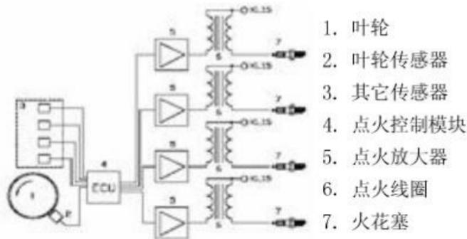
每缸有一独立的点火线圈，是当今最为先进的点火系统。这种点火系统分为两种类型：单点火(CPC)、集成点火(COP)；集成点火系统将点火线圈集成在火花塞上，单点火则用一根高压线从点火线圈接到火花塞。
