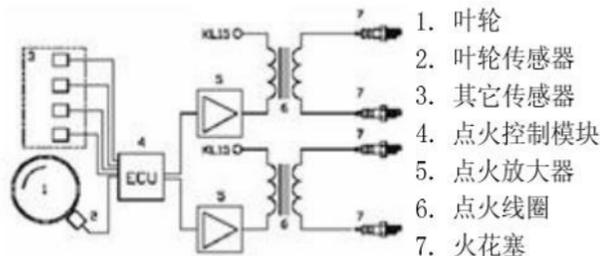
双点火系统完全由电子器件组成，没有机械部件。每两个缸共用一个点火线圈，线圈次级的两个电极分别接一个火花塞。也就是说总是有两个火花塞同时点火，其中一个缸处于正常点火，另一个缸则处于排气过程中(点火
